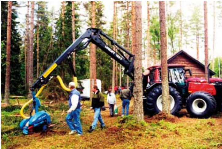
Ciągnik Valtra z głowicą harwesterową KETO 51, zawieszoną na żurawiu LOGLIFT 120V (fot. K. Jodłowski)
