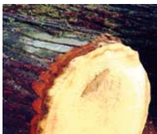
Na przekroju widoczne: wielordzenność, zakorek, zarośnięty sęk (drewno dębowe) (fot. J. Witkowska, G. Ślęzak)
