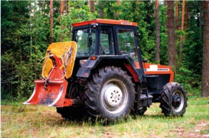
Ciągnik rolniczy z wciągarką Herkules 1500 o sile uciągu około 15 kN (fot. K. Jodłowski)
