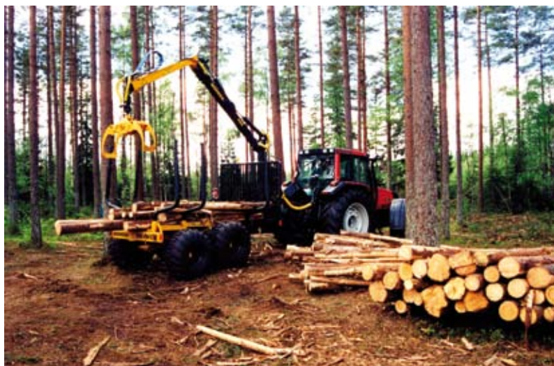
Przyczepka leśna samozaładowcza MOHEDA, agregatowana z ciągnikiem rolniczym (fot. K. Jodłowski)
