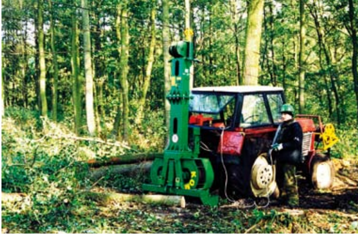
Czeska kolejka Larix Kombi. Wymaga agregatowania z ciągnikami o mocy 50-75 kW (fot. K. Jodłowski)
