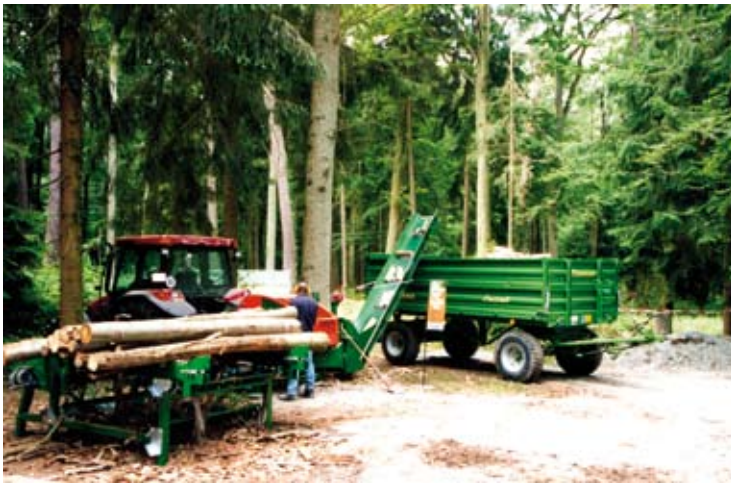
Przykład przewoźnego zestawu do produkcji drewna kominkowego złożonego ze stołu podawczego, pilarki do przerzynki kłód, łuparki, przenośnika i przyczepy do przewozu szczap. Napęd pilarki i łuparki przekazywany jest od ciągnika rolniczego (fot. K. Jodłowski)
